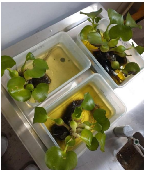
Figura 4. Lirios acuáticos en contacto con diferentes soluciones de cromo.
